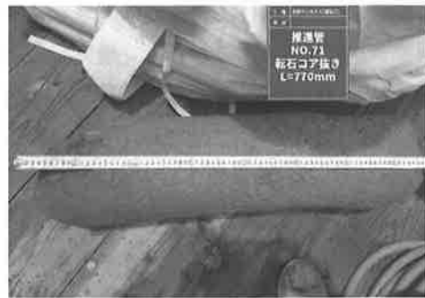
写真-8 破碎排土された岩盤 770mm
