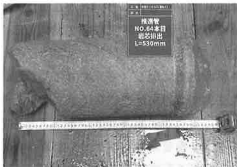
写真-7 破碎排土された岩盤 530mm
